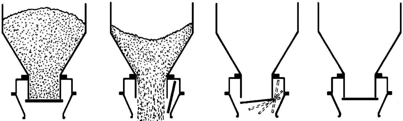
Bild 3: Schematische Darstellung der Klappenverschlussmechanik bei einer Vollentleerung
