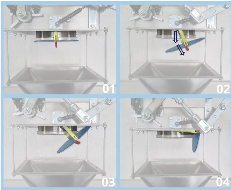
Bild 2: Klappenverschluss Mechanik
