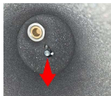
Den Bolzen im Inneren der Schallschutzhaube von Hand herausziehen
