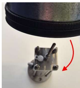
Schallschutzhaube über den Klopfer stülpen, Bolzen durch Gummitülle führen
