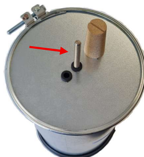
Klopfer und Schallschutzhaube mit durchgestecktem Bolzen
