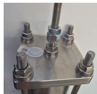
Klopfer mit montiertem Haltebolzen für die Schallschutzhaube
