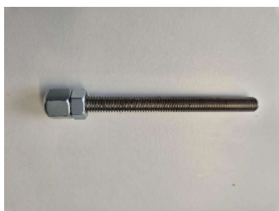
Herausgezogener Bolzen mit Doppelmutter zum Anbringen an Klopfer
