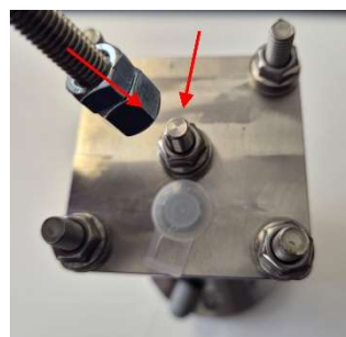
Bolzen auf den Zentralbolzen des Klopfers aufschrauben
