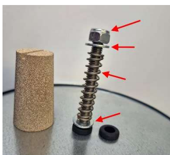
Mutter, Feder und Scheiben am Deckel der Schallschutzhaube entfernen
