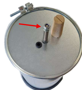
Scheibe, Feder, Scheibe auf den Bolzen aufsetzen und Mutter anziehen
