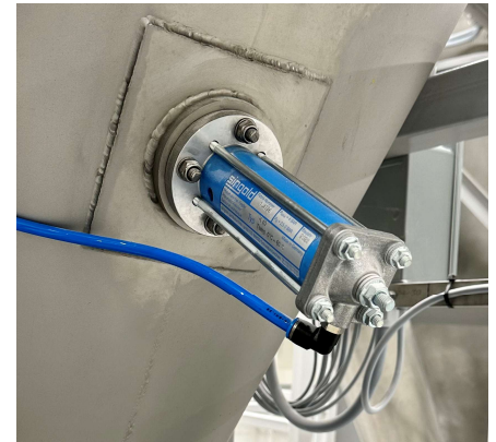
Рис. 1 Пневматический молоток singold K 40
